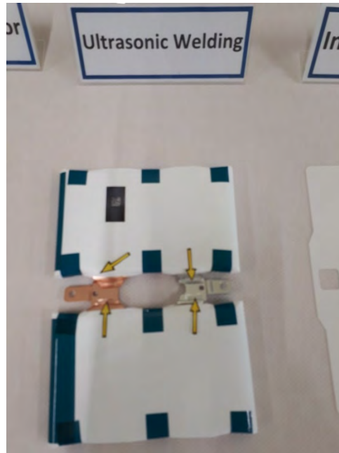
Kész, szigetelő réteggel bevont, fülhegesztett jellyroll
